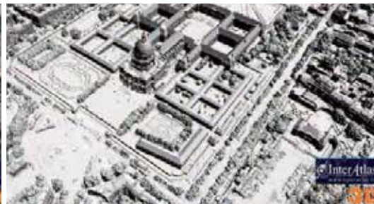
Reconstruction 3D de Paris par Acute3D à partir de 150,000 photos aériennes InterAtlas (ici les Invalides). Le rendu en éclairage artificiel sans couleur illustre la précision de la reconstruction.
